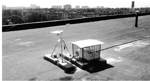
Аппарат «Burkard Sporewatch Trap», улавливающий пыльцу растений, установленный на крыше Одесской обласной клинической больнице
